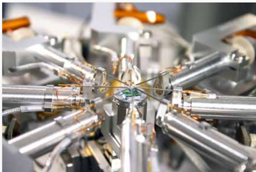
完全にプログラム化された 8 本 nanoプローバーシステム(nProber)
