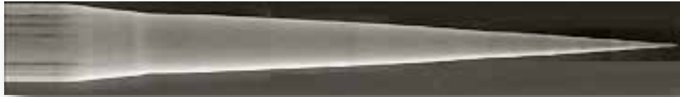
プローブのSEM合成写真(軸から先端まで)細長い形状により小さなところまでプローブが可能です(nProber)
